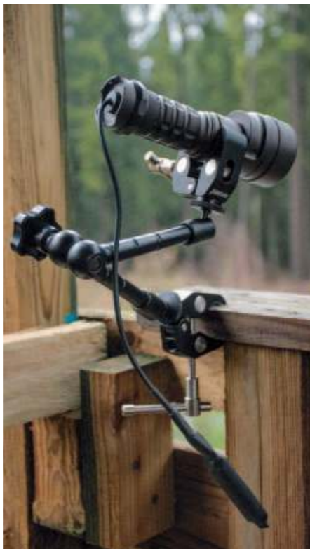
Ein Klemmstativ ist eine Möglichkeit, die Lampe am Sitz zu befestigen.
